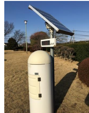
市民会館など公共施設には必ず線量計が設置されています。
